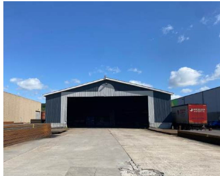
Antal etager: 1 Rumhøjde i begge haller: 6-8,5 m Aflang hal med 1 etage og mulighed for at tilføje et etagedæk. Uden tilbygninger. Hallen er opdelt i en isoleret og en uisoleret hal.
