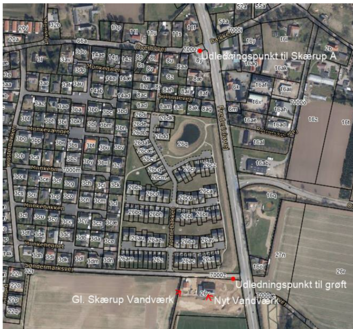
Figur 1: Luftfoto af nyt vandværk i Skærup, udledningspunkt til vejgrøft og grøftens tilslutningspunkt til Skærup Bæk
