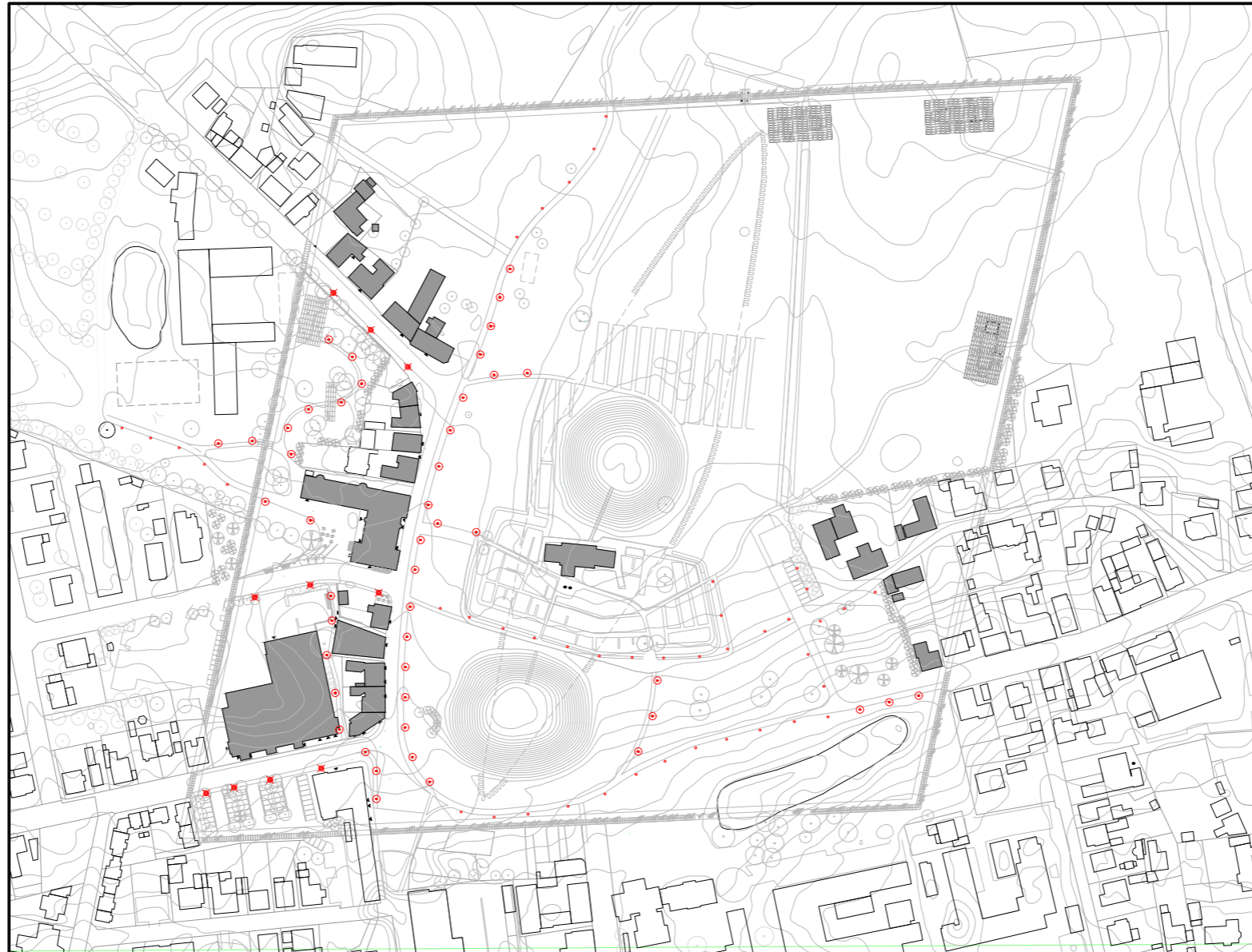
Placering lyspullert og mastbelysning 1:3000
