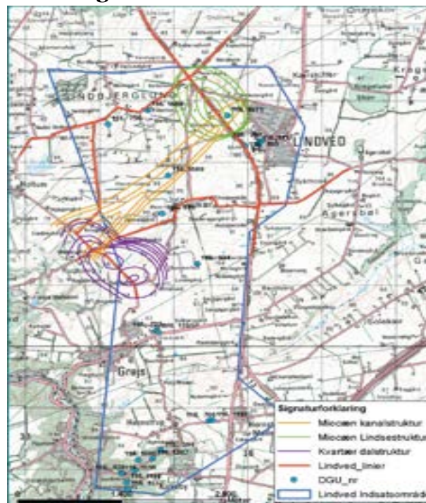
Kort over kanal- og linsestruktur (gul og grøn) samt begravet dal (Kvartær dalstruktur, lilla/AAR35) (Naturstyrelsen 2011)
