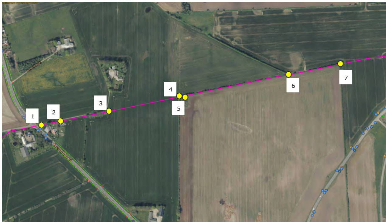
Figur 4-5 Dræn umiddelbart nord for projektområdet, markeret med lyserød linje, gule cirkler markerer omtrentlig placering af brønde.
