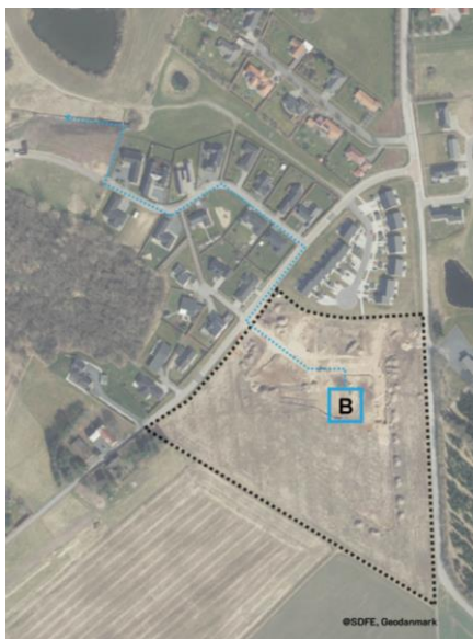
Figur 2.1: Eksempel på angivelse af placering for fremtidige regnvandsledninger og forsinkelsesbassiner samt udledning til recipient.
