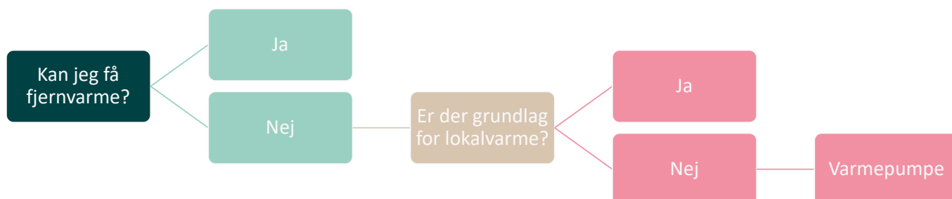
Figur 2: Simpelt diagram der viser, hvordan både fjernvarme og lokalvarme er undersøgt, inden Vejle Kommune anbefaler individuelle varmepumper.
