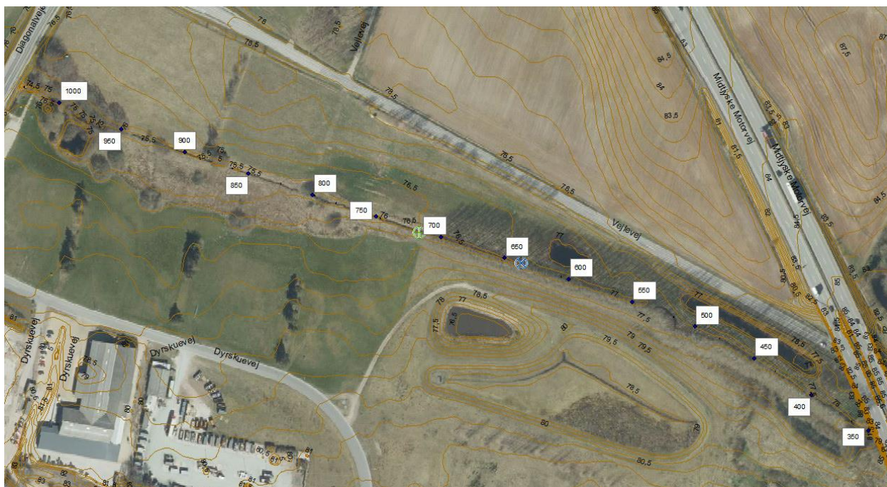
Figur 16 – Kort med der viser 0,5 m terrænkoter. Grønne cirkler er rørdløb fra venstre set nedstrøms. Blå cirkler er rørdløb fra højre, set nedstrøms.
