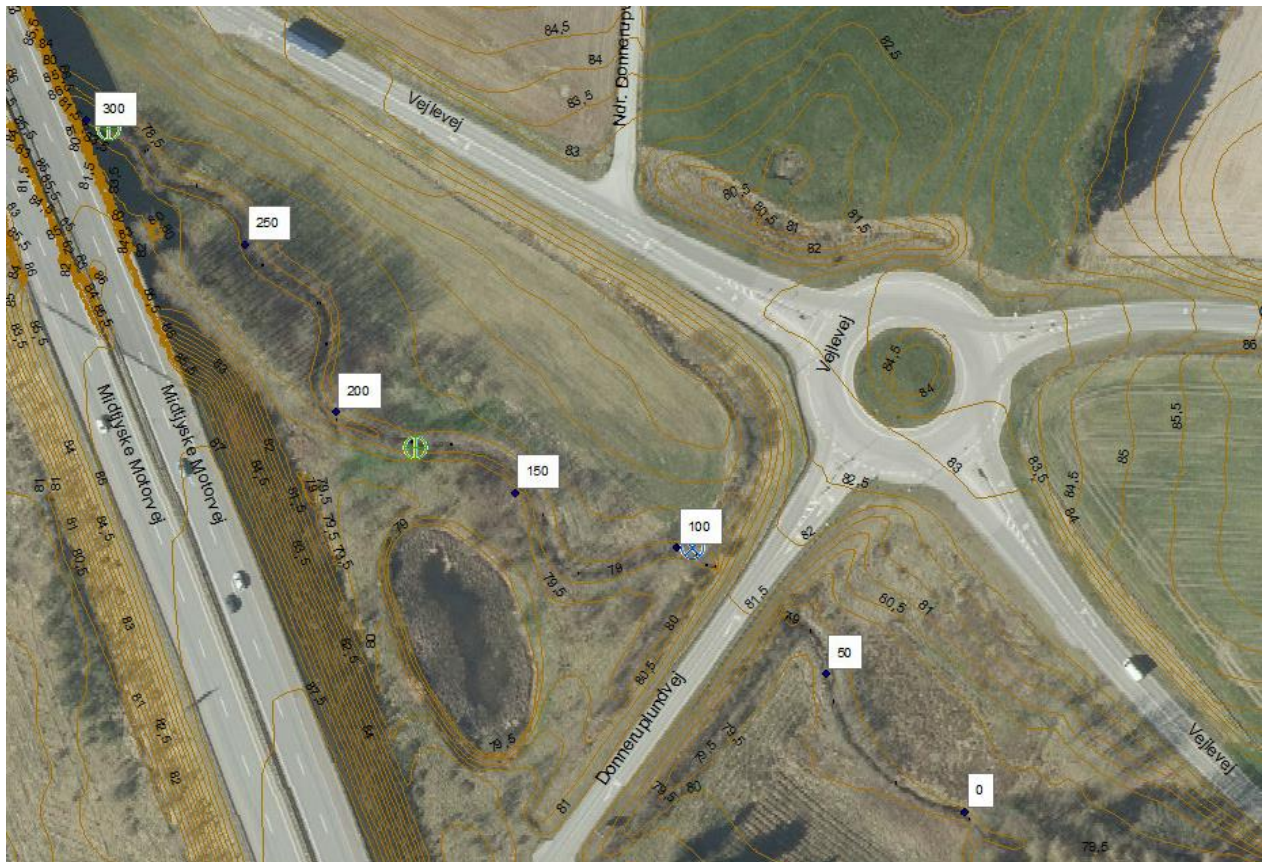
Figur 12 – Kort med der viser 0,5 m terrænkoter. Grønne cirkler er rørudløb fra venstre set nedstrøms. Blå cirkler er rørudløb fra højre, set nedstrøms. Stationering fra opmålingen vises i boksene.
