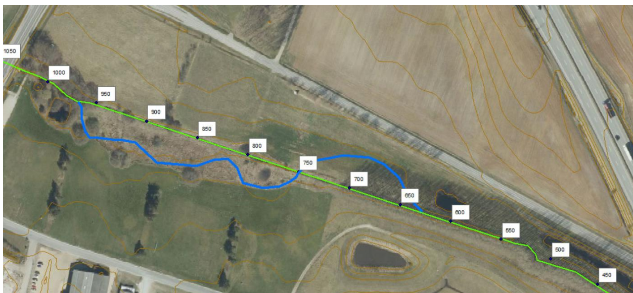
Figur 17 - Skitseforslag til nyt vandløbsprofil ses med blå linje.
