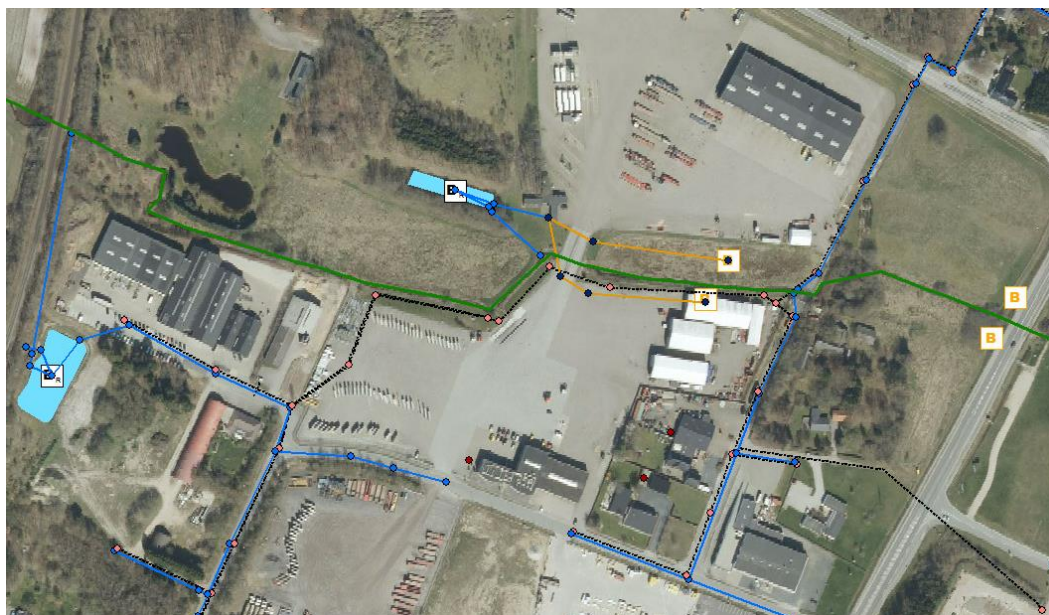
Figur 20 - Luftfoto med regnvandsbassiner og ledninger – både private og offentlige. Udløbet fra regnvandsbassinet længst mod vest ved jernbanen er forkert. Udløbet er reelt på nedstrøms side af jernbanen.
