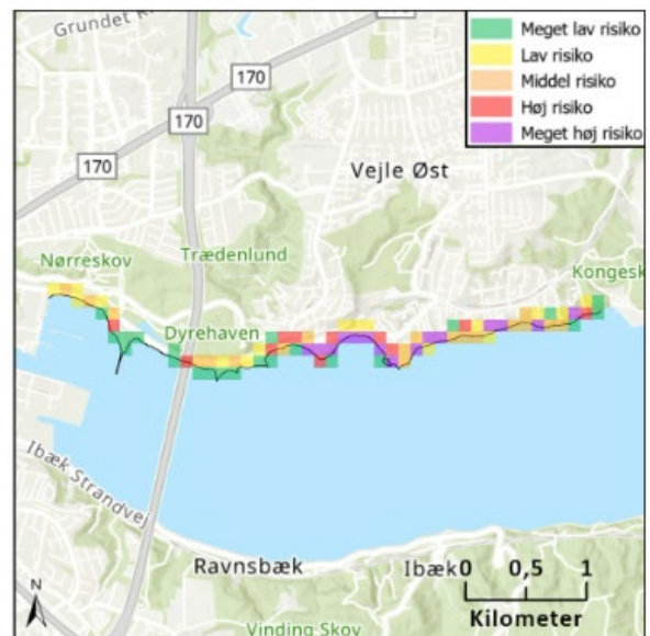
Figur 38 Risikoen for erosion på delstrækningen på nordsiden af Vejle Fjord indenfor 100 år.
