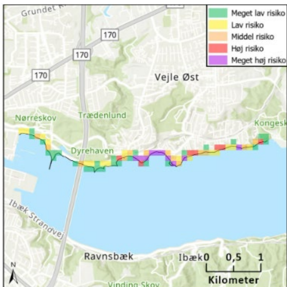
Figur 37 Risikoen for erosion på delstrækningen på nordsiden af Vejle Fjord indenfor 50 år.
