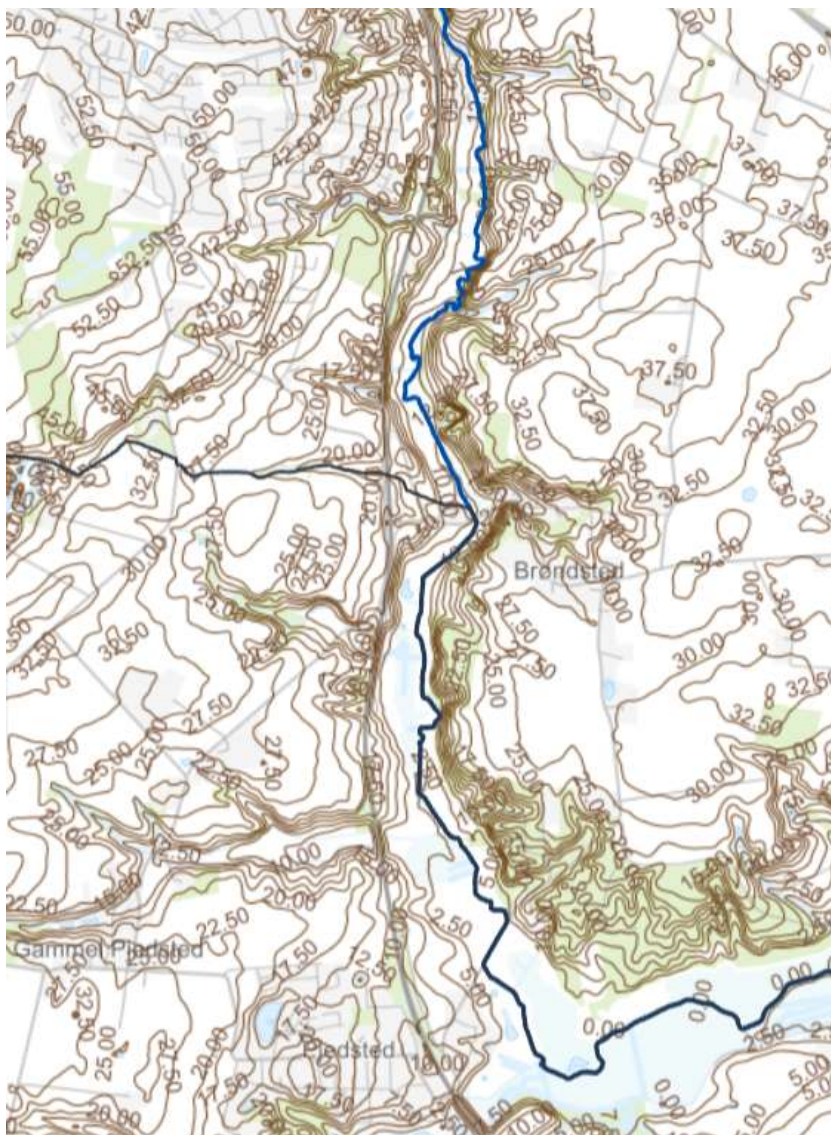
Figur 2 – Kort med der viser 2,5 m terrænkoter. Tydelig bakker på begge sider af vandløbet. Vandløbet er vist med blå .
