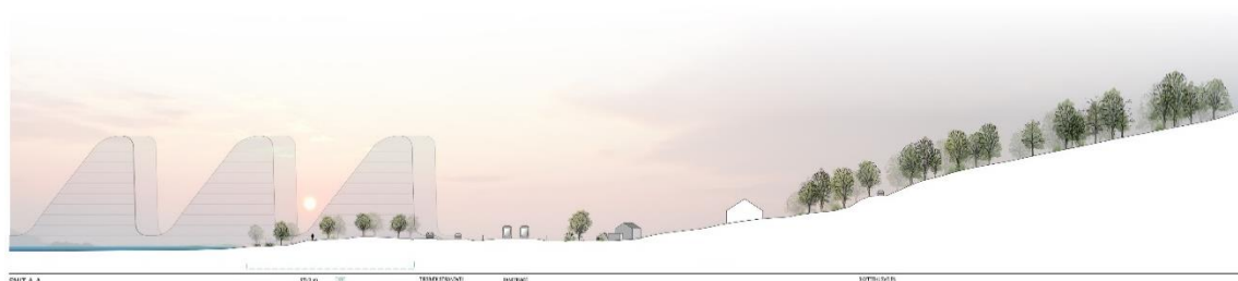
Figur 31: Tværsnit af Membranen med illustration af det landskabelige dige med stiforbindelse for situationsplanen snit A-A. Kilde: COWI/Arkitema
